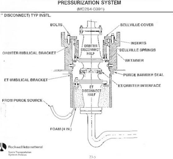
COMPONENT: DISCONNECT, GH2/GO2 ORBITER TO TANK PRESSURIZATION SYSTEM
